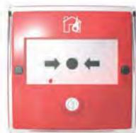
Pulsador manual de alarma rearmable de superficie de color rojo con tapa de protección incluida. Uso exclusivo en interiores. Incluye tres tipos de activación seleccionables: por diodo zener (para identificar como pulsador en zona de centrales Vision), por contacto NA/NC o por resistencia de 470Ω.
