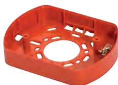
Base alta rectangular de superficie color rojo para sirena NS4/R (Protección IP54). Permite tubo de hasta 22mm de diámetro.
