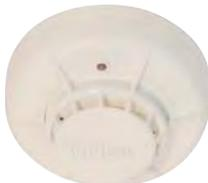
Detector convencional térmico-termovelocimétrico (58°- 8°C/minuto) con led de señalización. Supervisión de funcionamiento mediante parpadeo del led. Microsensor incorporado, activable mediante haz de rayo láser codificado para prueba remota. Salida para piloto indicador de acción.
