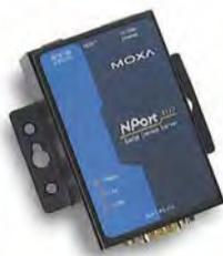
Equipo redireccionador de la información del puerto serie RS-232 de la central al PC remoto de gestión TG mediante protocolo IP. Compatible con redes Ethernet 10 y 100 MHz. Requiere conexión Ethernet RJ45 y 24V.
