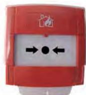
Pulsador manual de alarma rearmable de color rojo para sistemas convencionales. Diseñado para uso exclusivo en interiores y montaje empotrado o superficie. Incluye 2 tipos de activación seleccionables: Contacto NA o resistivo de 470 Ohms.
