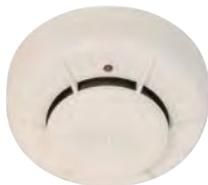
Detector de humos óptico convencional de perfil extraplano con led de señalización. Supervisión de funcionamiento mediante parpadeo del led. Diseño de cámara que reduce los efectos de la suciedad y accesible sin necesidad de herramientas especiales para mantenimiento. Microsensor incorporado, activable mediante haz de rayo láser codificado para prueba remota. Salida para piloto indicador de acción.
