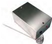
Sensor de temperatura termostático regulable de 50 a 300°C en caja de acero inoxidable de 0,8 mm con prensaestopa para tubo. Funciona como un sensor convencional conectándose al circuito de zona de la central. Una vez superada la temperatura seleccionada el sensor entra en alarma y permanece enclavado en este estado hasta el rearme de la central. Incorpora un led que se ilumina cuando el detector se activa.
