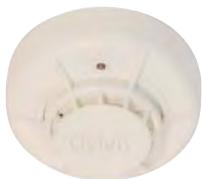
Detector convencional de temperatura (58°C) con led de señalización. Supervisión de funcionamiento mediante parpadeo del led. Microsensor incorporado, activable mediante haz de rayo láser codificado para prueba remota. Salida para piloto indicador de acción.
