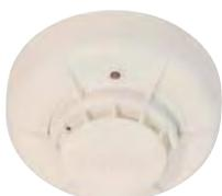
Detector convencional de alta temperatura (78°C) con led de señalización. Supervisión de funcionamiento mediante parpadeo del led. Microsensor incorporado, activable mediante haz de rayo láser codificado para prueba remota. Salida para piloto indicador de acción.
