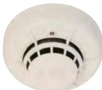
Detector óptico de humos y térmico-termovelocimétrico (58°- 8°C/minuto) convencional con led de señalización. Supervisión de funcionamiento mediante parpadeo del led. Diseño de cámara que reduce los efectos de la suciedad y accesible sin necesidad de herramientas especiales para mantenimiento. Microsensor incorporado, activable mediante haz de rayo láser codificado para prueba remota. Salida para piloto indicador de acción.
